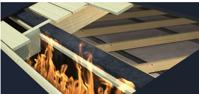
Kuva 4. Varmista että mikään ei estä tai rajoita palokatkonauhaa turpoamasta vapaasti palon sattuessa.
